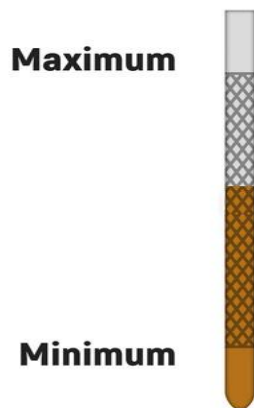
Abb.: Der korrekte Motor-Ölstand gemessen mit einem Ölmessstab
